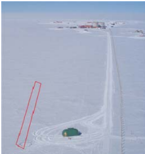
Fig. A4.2 - Area su cui sono state effettuate le misure BRDF (all'interno del riquadro rosso). Le misure sono state eseguite in 8 siti ad intervalli distanziati di circa 10m
