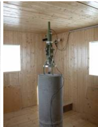
Disposizioni delle mire e relativi azimut e foto del teodolite giroscopico Wild GAK 1
