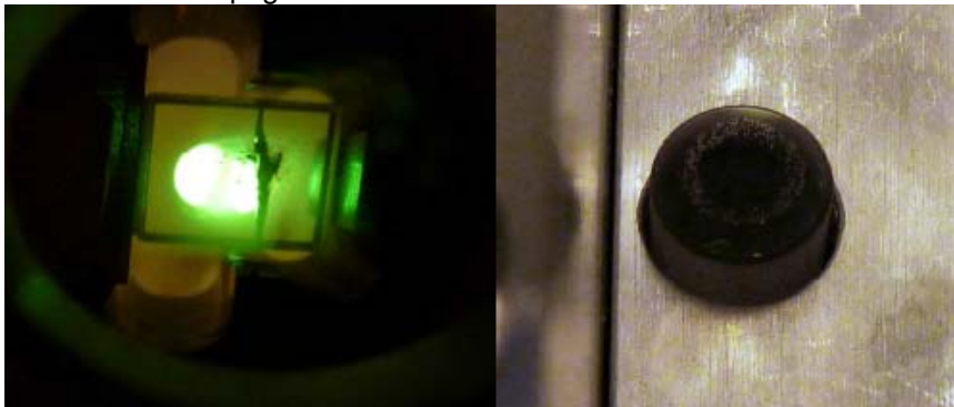
Immagini dei danni trovati aprendo il laser: generatore seconda armonica spezzato termicamente e barretta Nd-YAG del laser ticchiolata.
