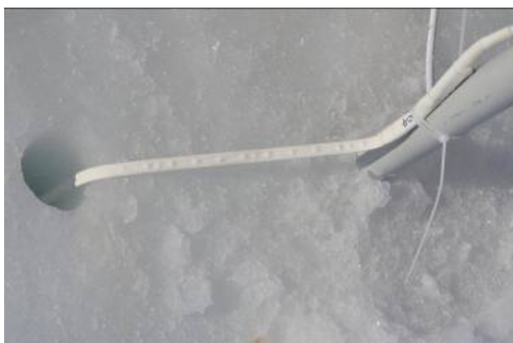
Fig. A2.3 - Catena di termistori in 'messa in opera'.
