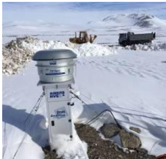
Fig. 7 – Campionatore PM10 a Boulder Clay
