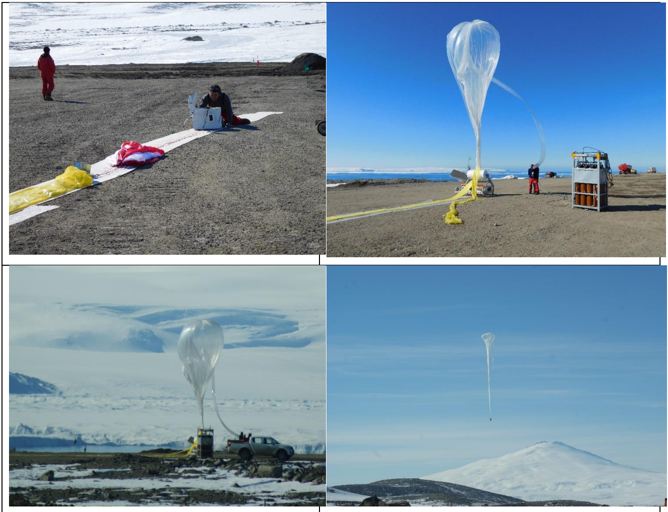
Figura 5 - Fasi preparatorie al lancio dello strumento DUSTER: a partire dall'immagine in alto a destra : set-up della catena di volo; fase di gonfiaggio del pallone stratosferico; rilascio del pallone e fase di ascesa
