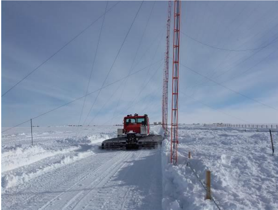
Foto 1 - Operazione di rimozione della neve con il PB270 nei pressi della schiera principale
