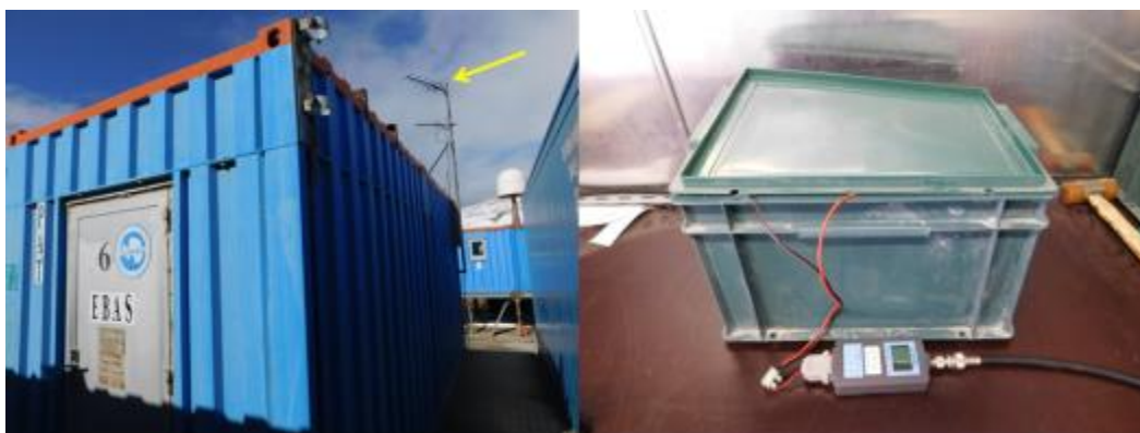
Fig. 24 - L'antenna yagi installata su container e la radio ricevente all'interno
