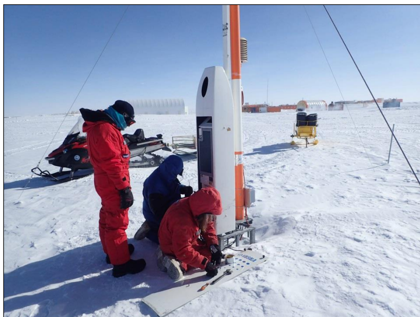
Fig. 2.2.1 - Smontaggio della Stazione Meteo AW11 in prossimità della pista aeroportuale
