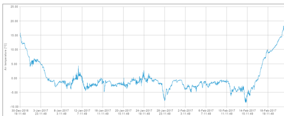
Figura 8 – Temperatura misurata dal termometro della nave durante la spedizione. La minima è stato di -8.7\text{ }^{\circ}\text{C} misurata il 14-02-2017 alle 08:02:42 UTC
