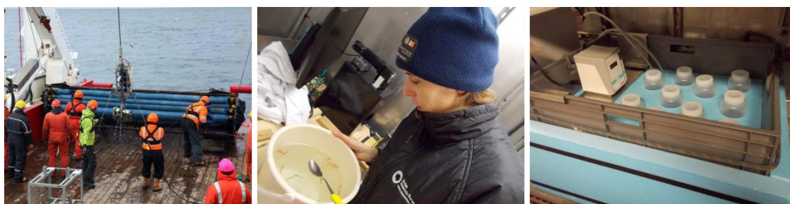
Figura 2 - Immagini rappresentative delle principali attività svolte durante la campagna antartica a bordo della nave inglese J. C. Ross. Da sinistra: campionamento di organismi marini (in foto, rete RMT 25); selezione degli organismi per i test di ecotossicità secondo specie, vitalità e classe di dimensione omogenea; esposizione a soluzioni contenenti NP in camera fredda, a temperatura controllata.
