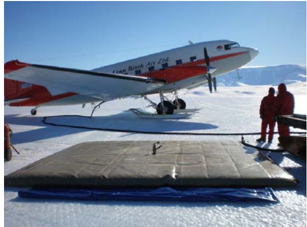
Riempimento del serbatoio collapsabile effettuato con lo scarico del combustibile dall'ala del Basler
