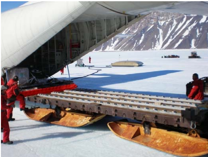
Lo slittone con rulliera, accanto alla rampa dell'Hercules, pronto per lo scarico dei materiali. Sullo sfondo la rubber tank (ancora piena) che, collegata alla pompa e all'aereo, ha appena iniziato il rifornimento.
