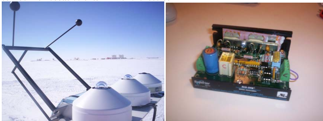
Fig.2.4 - Inseguitore solare in funzione per qualche giorno durante la campagna. Le schede che hanno creato problemi sono le SLO-SYN della Superior Electric.
