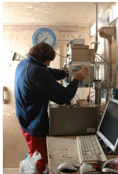
Fig 2.9 - Il sistema DMPS sullo sfondo con Grimm e PSAP in alto. In primo piano il PC.
