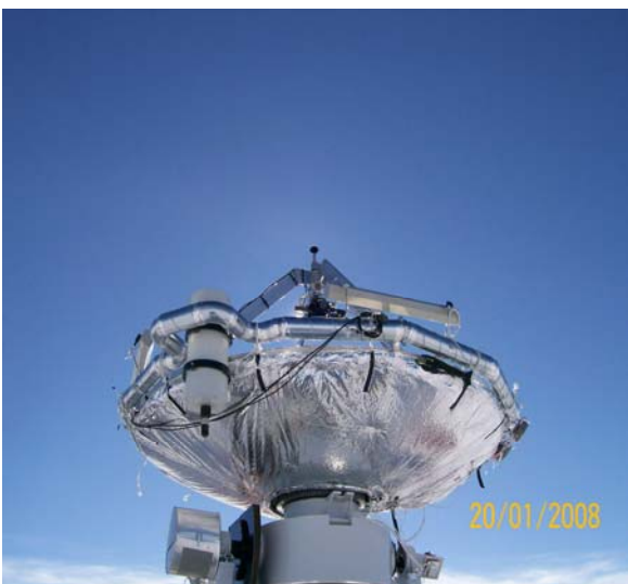
Fig. 2.15 - Sistema di defrosting dello specchio primario
