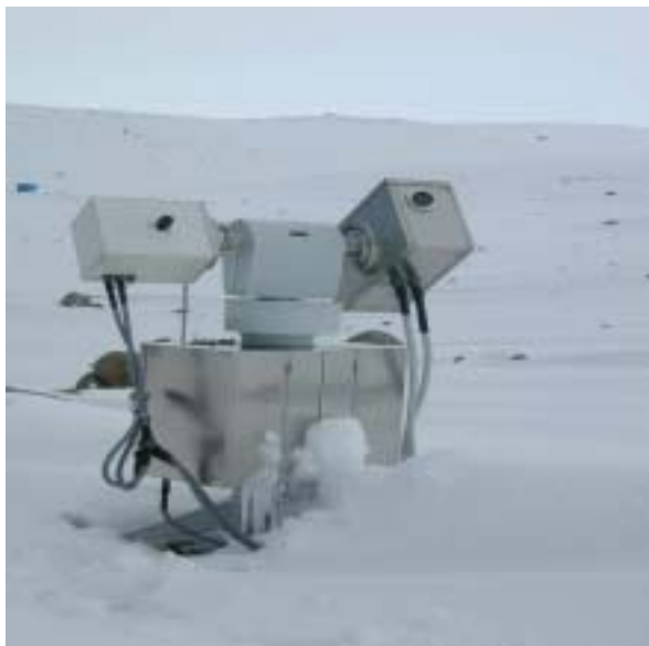
Fig. 6.7.1: Il fotometro solare multispettrale (a sinistra) ASP-15WL e l'inseguitore solare.
