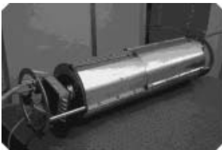
Fig. 11.8.2 - Sorgente laser Nd:YAG utilizzata nel payload sottomarino
