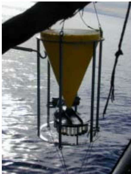
Trappola per sedimenti automatica
