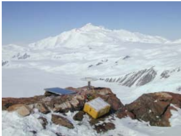
Fig. 2.1.3 - Immagine di strumentazione GPS in acquisizione sul punto VL14
