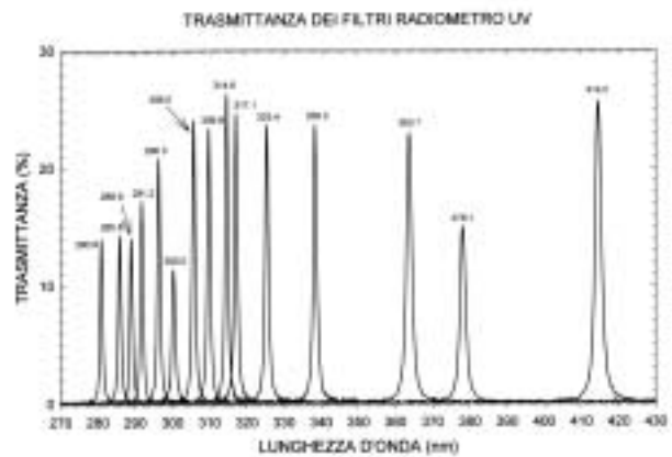
Fig. 11.11.2 – Curve di trasmittanza del set di filtri dei radiometri UV-RAD
