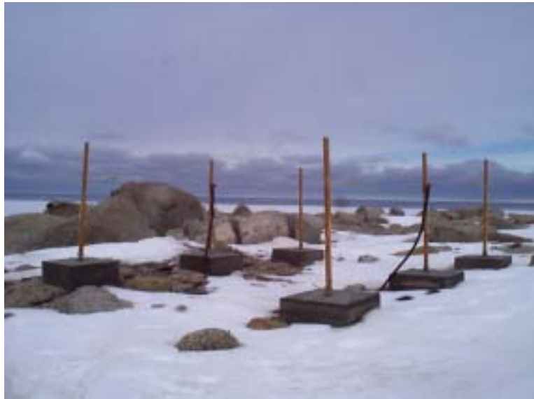
Fig. 3a.9 - Antenna del sistema RIO01 dell'Osservatorio Riometrico di Baia Terra Nova.
