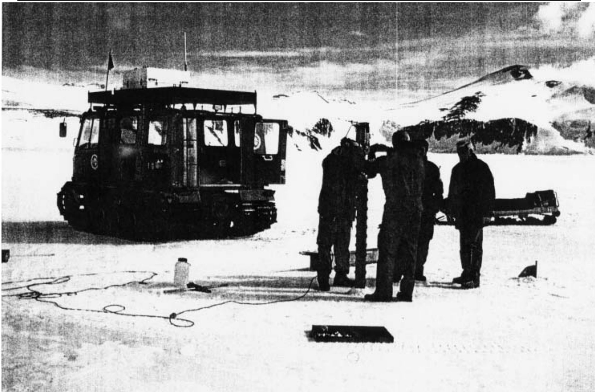
Baia Terra Nova – Perforazione del ghiaccio marino per l'introduzione di un profilatore acustico di corrente a lettura diretta
